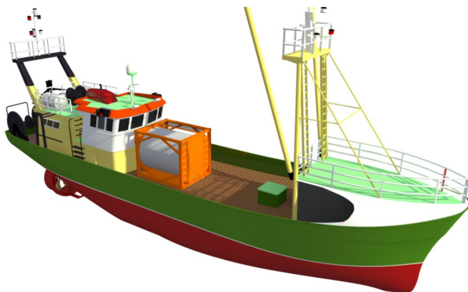
Figuur 19: Artist impression kotter TH10 met LNG tankopslag aan dek. (credits Zvb P.A. Baaij - Koers & Vaart)
